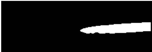
Fig. 4.4 Imagen binaria que resulta de aplicar un umbral de 210 a la imagen ilustrada en la Fig. 4.2.
