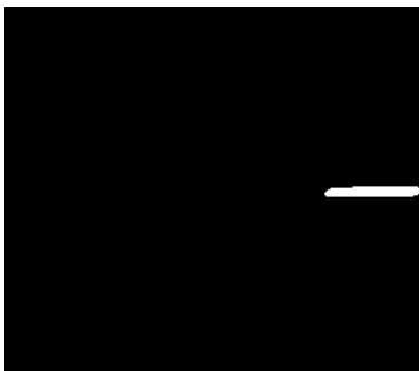
Fig. 4.5 Imagen binaria que resulta de aplicar un umbral de 210 a la imagen mostrada en la Fig. 4.3e.
