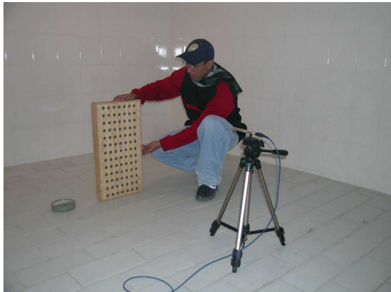
Fig.7 Pruebas a un resonador múltiple en la cámara reverberante
