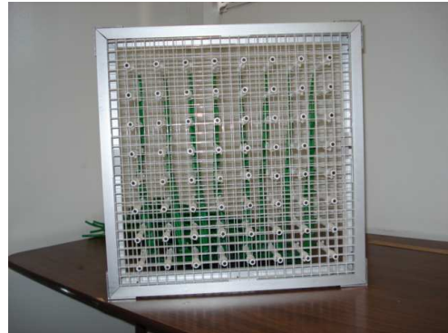
Figura 1. Estructura de soporte para el arreglo de micrófonos.
