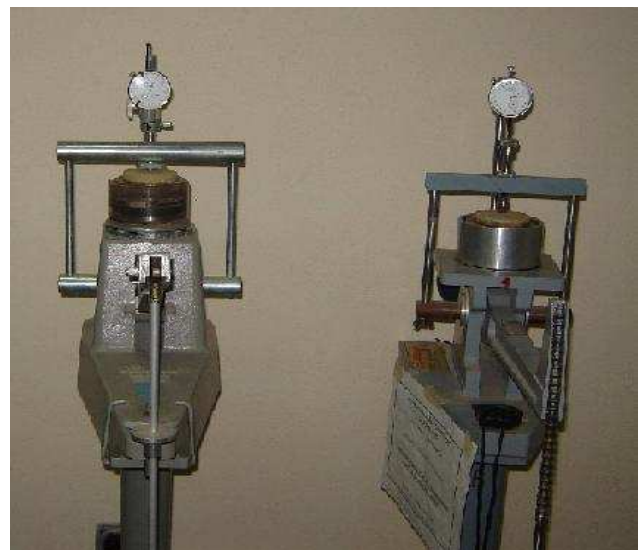
Fig. 3.- Consolidómetro tradicional en funcionamiento con micrómetro para la medición del desplazamiento del suelo.
