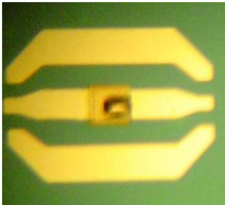
Fig. 2 Imagen óptico de resonador FBAR
