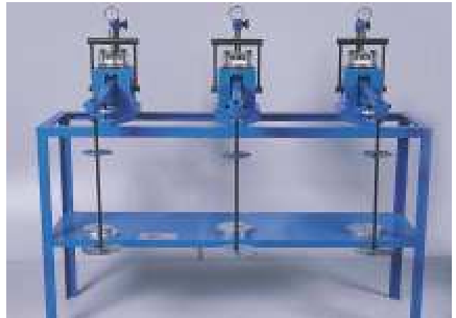
Fig. 2.- Bancada de tres consolidómetros de la marca Controls®.
