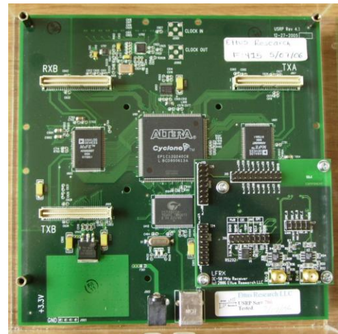
Figura 13: El Universal Software Radio Peripheral de Ettus Research. Abajo a la derecha, un bloque de RF; al centro, el FPGA y a sus lados, los convertidores DA y AD. En la parte inferior, la interfaz USB a una computadora personal.
