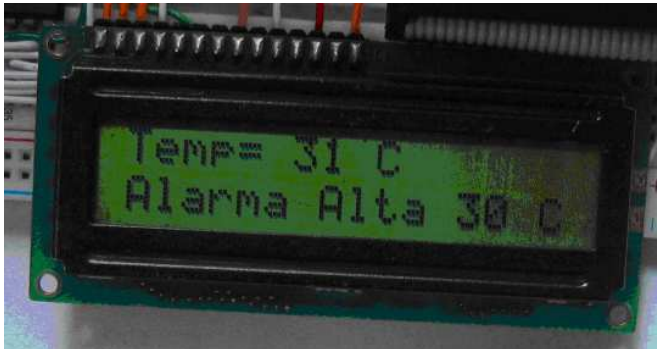
Fig. 17 Indicación local de la activación de una alarma
