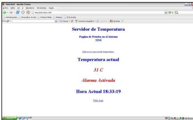
Fig. 18 Indicación remota de la activación de una alarma
