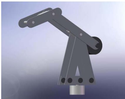
Fig. 2. Representación conceptual de un brazo robótico de tipo angular.
