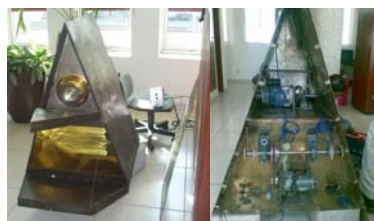
Figura 1. Fotografía del sistema. A la derecha se observan las dos puertas y a la izquierda la parte posterior mostrando los motores.
