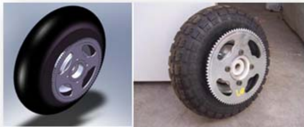
Fig. 5 Comparación entre el diseño CAD de las llantas y su sistema de engranaje, con el utilizado en el prototipo.
