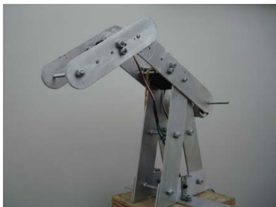
Fig. 3. Prototipo de brazo robótico de 3 GDL.
