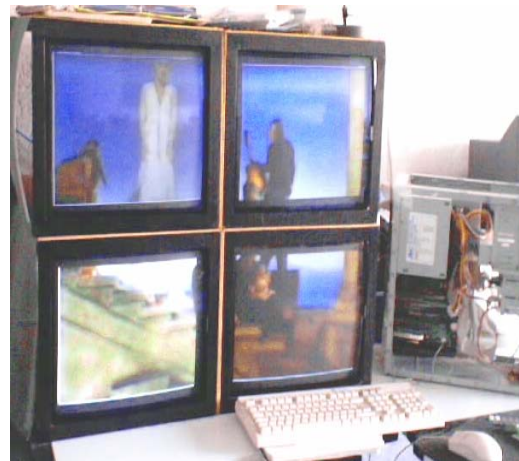
Figura 8: Video-wall de 4 monitores a pantalla completa
