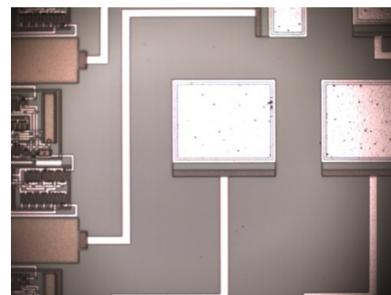
Figura 8. Microfotografía (50x) de microelectrodo de 200\mu\text{m} por lado.
