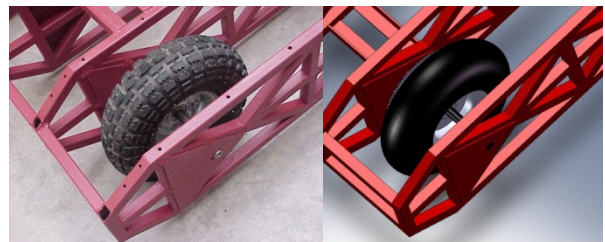
Fig. 8 Comparación entre el diseño CAD de la transmisión y el sistema real de XRunner
