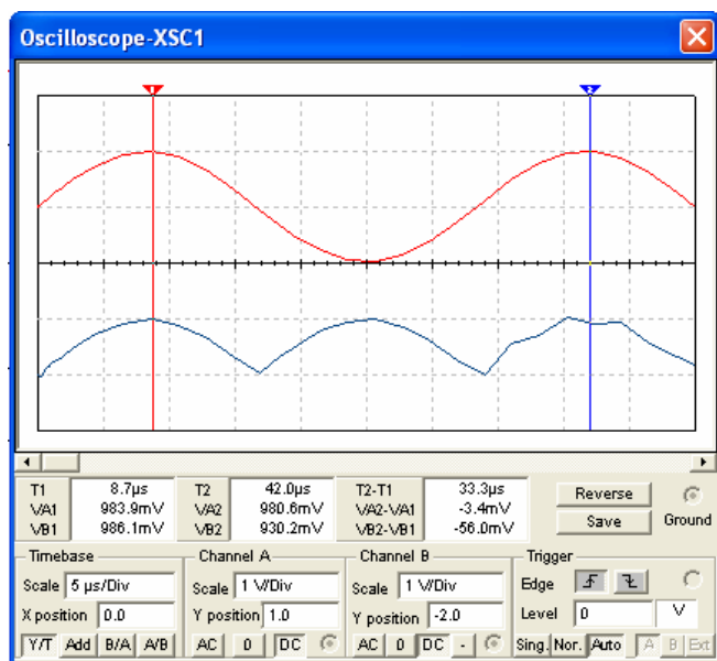
Figura 10.- Resultados de la simulación del rectificador de precisión.
