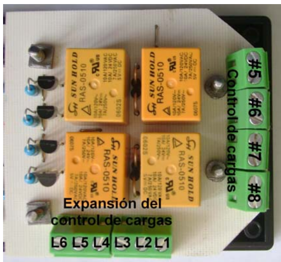
Fig. 5. Fotografía del módulo de cargas desmontable
