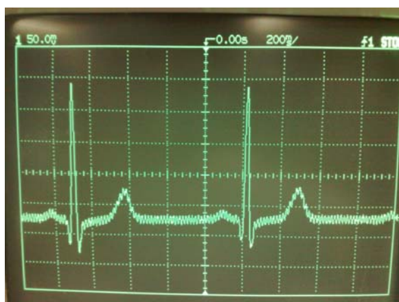
Fig. 2 ECG a la entrada del convertidor A/D LTC1407A-1.
