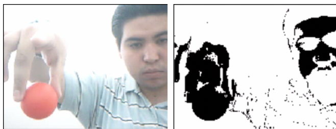
Fig. 4. Detección de color de un objeto. Note que el color del objeto puede confundirse con otros objetos.
