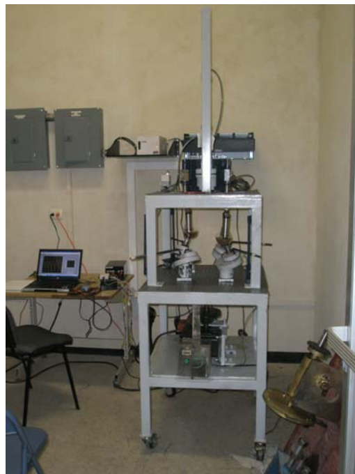
Figura 4. Simulador de cadera FIME II.
