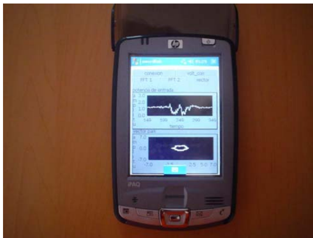
Figura 5: Visualización de la Potencia de Entrada y el Vector de Park en la PDA.
