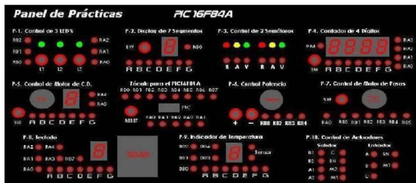
Fig. 3.- Se muestra el panel de prácticas, con las diferentes conexiones para los 10 ejercicios propuestos en el tutorial.
