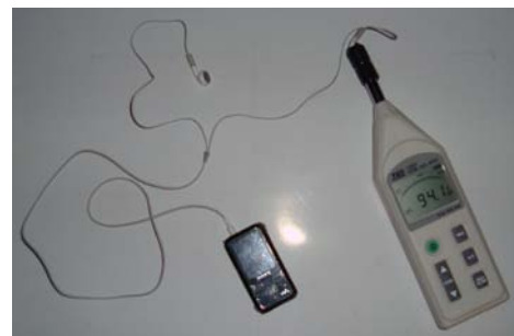
Fig. 2 Arreglo de medición para la evaluación electroacústica de iPods
