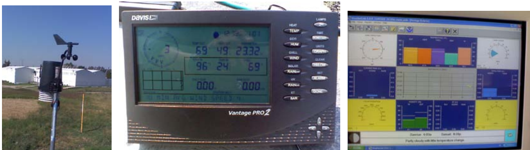
Fig. 16 Estación Meteorológica, monitor receptor de datos y programa de computadora.
