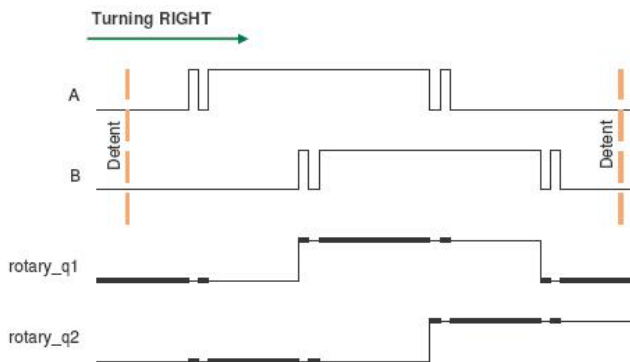
Fig. 16 Un filtro elimina rebotes y modifica señales internas
