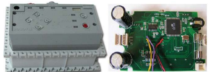
Figura 1. Módulo CM-5 y su placa controladora interna
