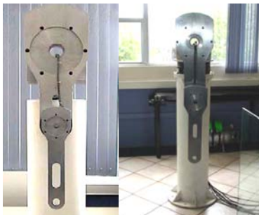
Fig. 1 Robot manipulador de transmisión directa de 3 grados de libertad.
