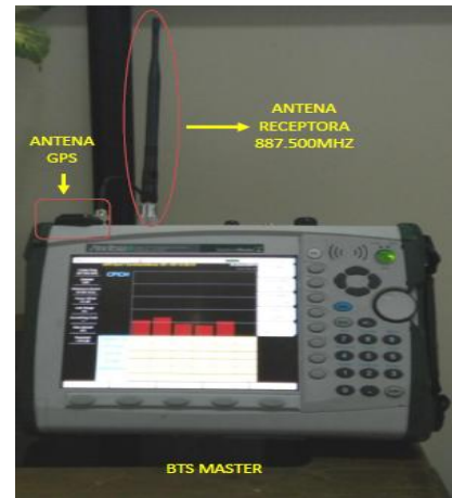
Fig. 3. Esquema de medición en el punto de Rx.
