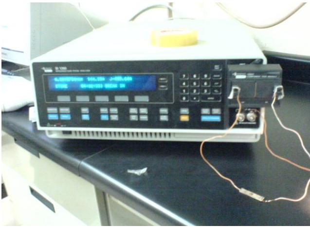
Fig. 2. Se observa el equipo Solartron 1294 utilizado para medir la impedancia eléctrica y obtener los espectros de impedancia.
