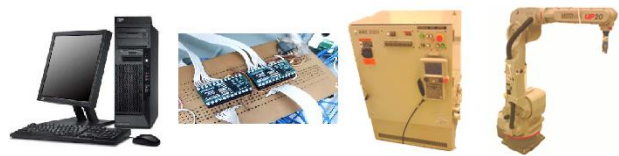
Fig. 10 Visualización total del sistema, de izquierda a derecha, PC, IH, XRC, MUP20.
