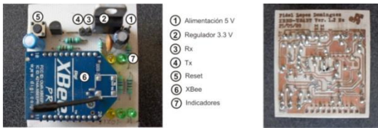
Fig 31. Placa transceptor en la plataforma
