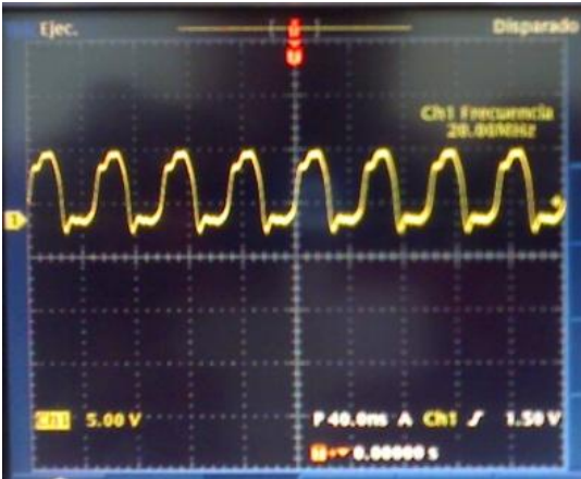
Fig.7 Señal obtenida por el circuito oscilador.
