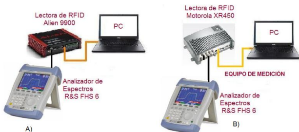
Fig. 3 Medición de la potencia de salida para A) Lectora RFID alién 9900 y B) Lectora RFID Motorola XR450.
