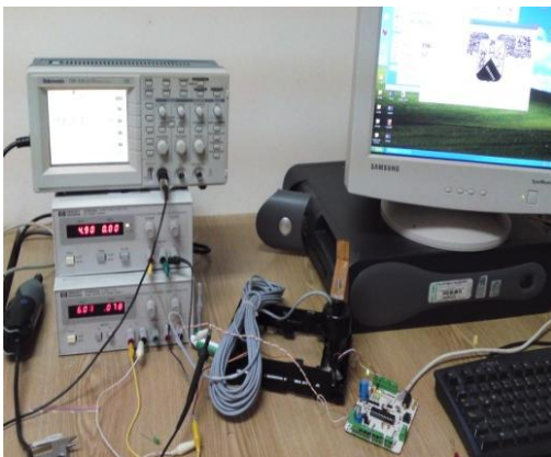
Fig. 13. Medición de rpm de motor de C.D.
