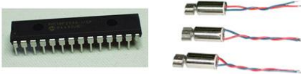
Fig. 3. Controlador PIC 18F2550 y micro motor/vibrador empleados para desarrollar el dispositivo háptico.
