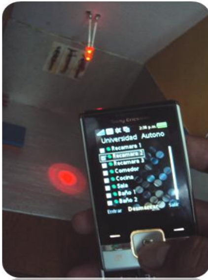
Fig. 5. Aplicación móvil desarrollada en JavaME, siendo ejecutada en un teléfono móvil marca Sony Ericsson modelo T715a.
