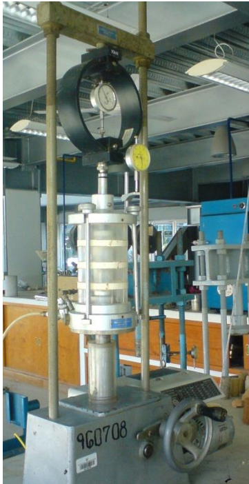
Fig. 1 Cámara triaxial típica (Lab. Mecánica de Suelos, Facultad de Ingeniería Civil, Universidad Autónoma de Chiapas).
