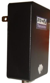
Fig. 6. Módulo Transmisor X-10 terminado
