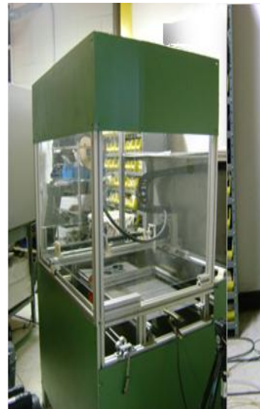
Fig. 1. Equipo de corte XY a base de plasma.
