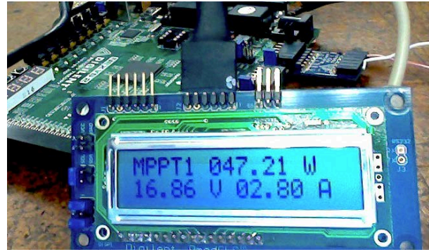
Fig. 7. Interfaz con el usuario mediante una LCD de 16x2.
