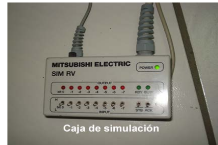
Fig. 12. Caja de simulación a la que llegan los bits y con ellos, asignar la rutina al brazo RV-M1.
