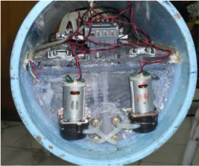
Fig. 9. Ubicación de los componentes en el casco del vehículo Sub-Chaac.
