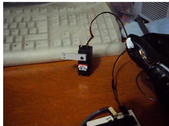
Fig. 13. Servomotor validando un movimiento del guante de adquisición de datos.
