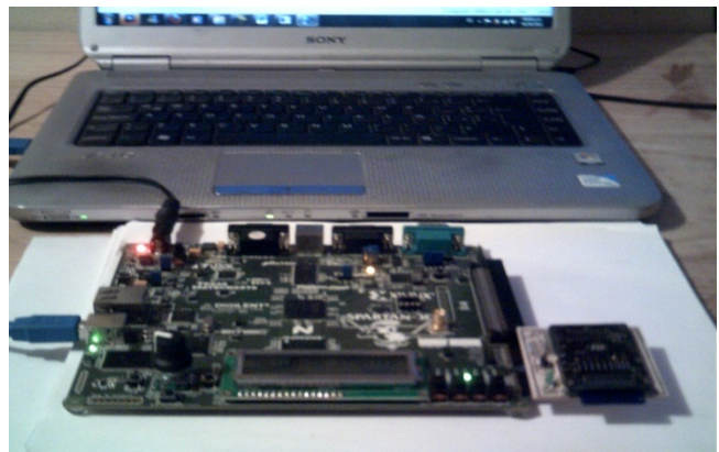
Fig. 6. Implementación del Módulo SD Card Reader en la tarjeta SPARTAN 3E.
