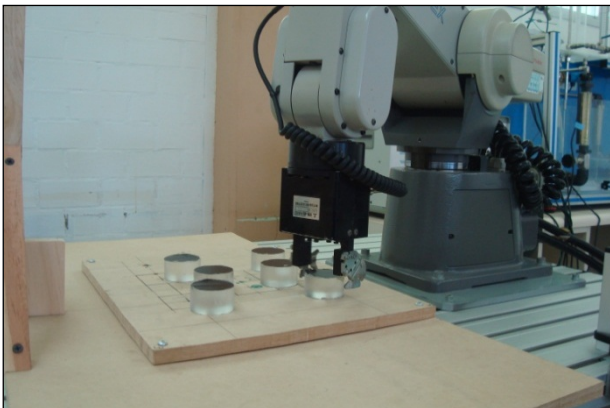
Fig. 17. Agarre del objeto por el centroide.
