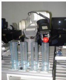
Fig. 10. El brazo se mueve hacia el contenedor adecuado para el color de la pelota para depositarla en el.
