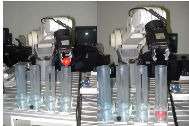
Fig. 13. Dos imágenes del proceso de clasificación de pelotas por color, enlazando la rutina desarrollada con el brazo de robot RVM1.
