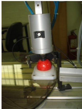
Fig. 19. El brazo Pick & Place se coloca para tomar la pelota.
