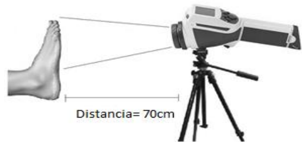
Fig. 1. Arreglo implementado para la captura de termogramas.
