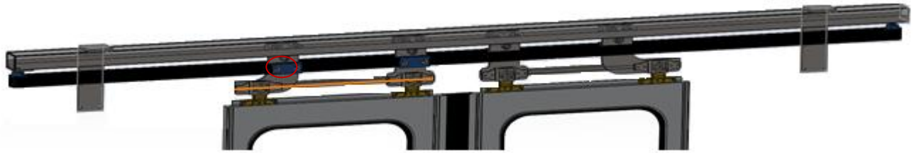
Fig. 5. Diseño con la banda y polea calculadas.
