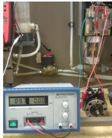
Fig. 5. Conexión de la Válvula de Control.
