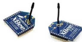
Fig. 5. Dispositivos XBee empleados en la comunicación inalámbrica.
