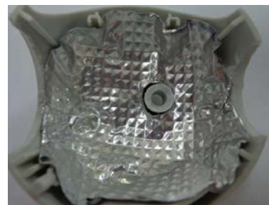
Fig. 8. Dispensor de luz integrado por una superficie reflejante corrugada.
