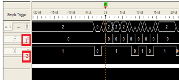
Fig. 15. Transmisión de datos de Labview al FPGA via WiFi y UART.
