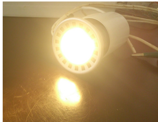
Fig. 14. Lámpara LED con voltaje en el TRIAC con ángulo de disparo menor a 90^\circ .
