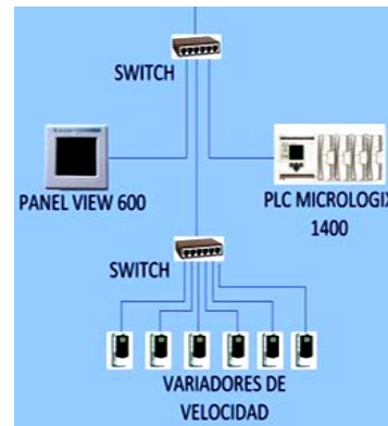
Fig. 18. Control de la banda principal.
