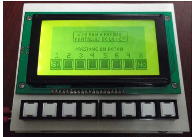
Fig012. Prototipo terminado del Sistema para Monitoreo Gráfico de Procesos Controlados por PLC'S.
