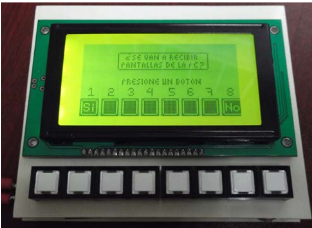
Fig. 8d. Prototipo terminado del Sistema para Monitoreo Gráfico de Procesos Controlados por PLC'S.
