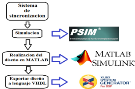
Fig. 10. Metodología para la implementación digital en el FPGA.
