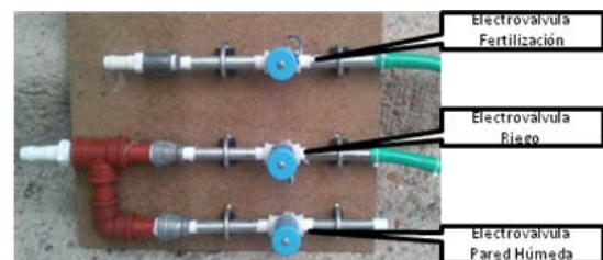
Fig. 4. Sistema hidráulico para la fertilización, riego y pared húmeda.
