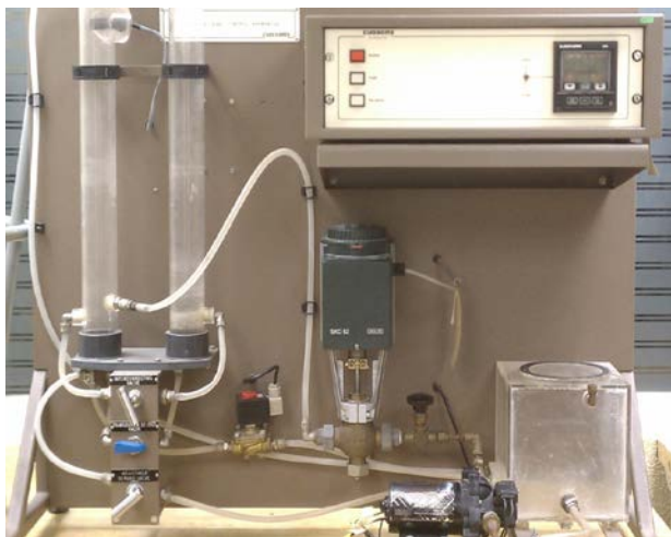
Fig. 1. Módulo de control de nivel de líquidos
