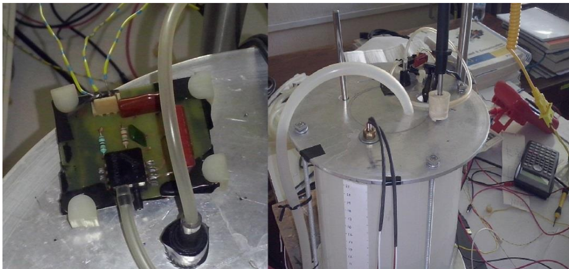
Fig. 13. Detalle de sensor de nivel por presión diferencial y sensor de temperatura termopar tipo K.
