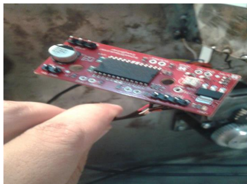
Fig. 9. Control del prototipo, Arduino Leonardo y driver.
