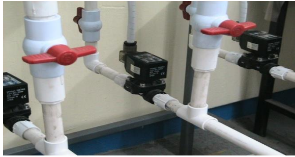
Fig. 5. Electroválvulas de acción directa.
