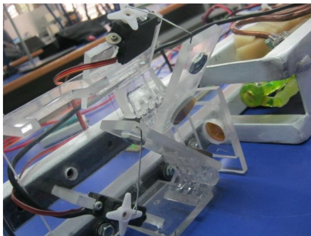
Fig. 4. Servomotores conectados a los espejos para control de grabado.
