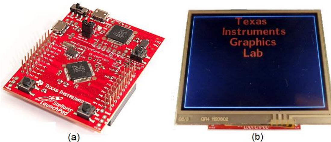
Fig. 1. Elementos empleados: (a) Tarjeta Stellaris LaunchPad y (b) Pantalla LCD-Touch.
