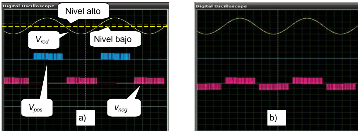
Fig. 4. a) Señal de entrada al PIC y los pulsos que genera el controlador. b) Voltaje de red muestreado y voltaje de salida del inversor.
