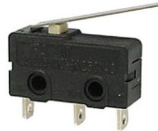
Fig. 8. a) Diagrama de tarjeta de puertos de entrada y salida; b) Interruptor de final de carrera.
