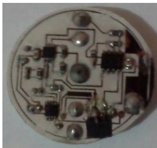
Fig. 12. Tarjeta PCB del prototipo artesanal montada en la espalda del electrodo.
