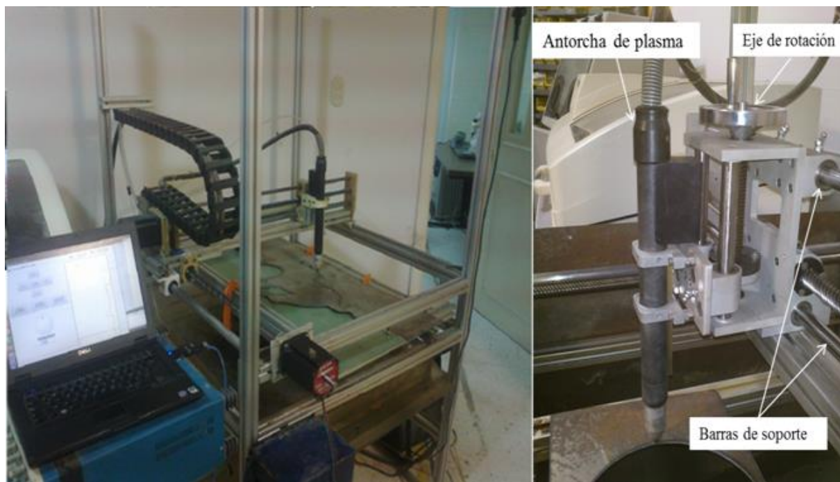
Fig. 1. Máquina de corte XY y detalle del eje X.
