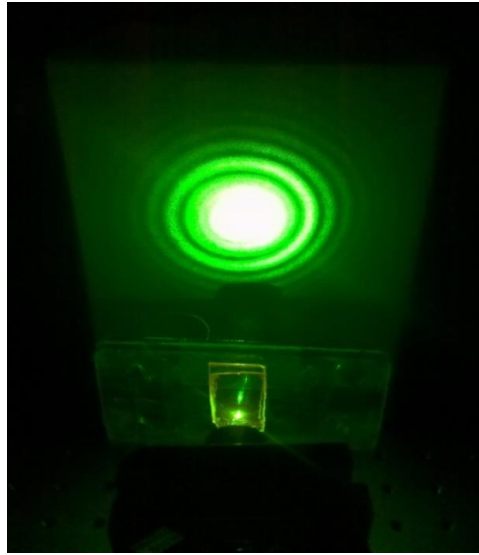
Fig. 4. Fenómeno de autoenfoco.
