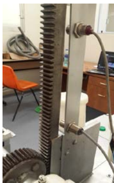
Figura 11 Mecanismo Cremallera-piñón para controlar la inyección.
