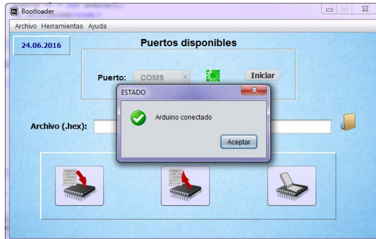
Figura 5 Comprobación de la conexión computadora-tarjeta.
