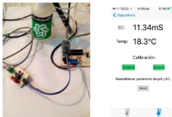
Figura 21 Instrumento para medir y visualización lectura EC.
