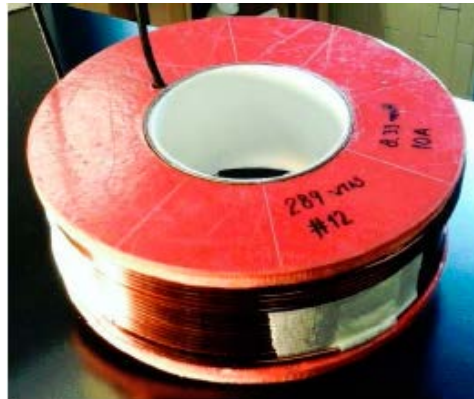
Figura 8 Aspecto del inductor de 8.0 milihenrys a 10 amperes.
