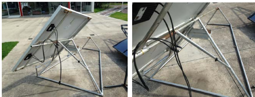
Figura 1 Estructura del seguidor solar.
