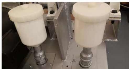
Figura 9 Contenedores para dosificar los materiales.
