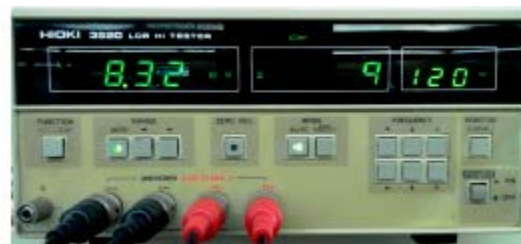
Figura 9 Medición en puente automático LCR; inductor 8.0 mH a 10 A.
