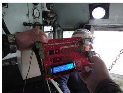
Figura 12 Recepción remota de la señal de velocidad de desplazamiento.
