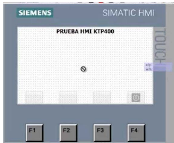
Figura 8 HMI Siemens KTP400.
