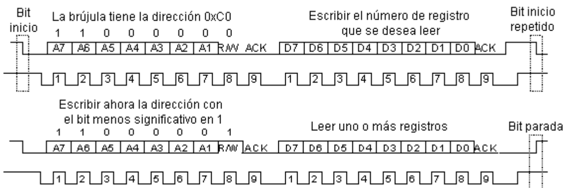
Figura 4 Trama de comunicación del bus I2C.
