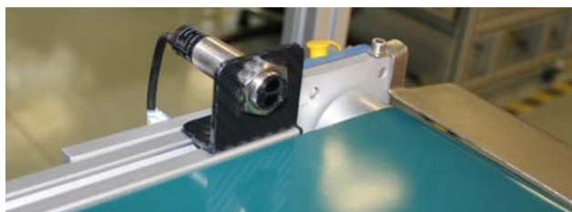
Figura 9 Sensor fotoeléctrico instalado en un extremo de la banda.
