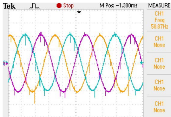
Figura 14 Señales de voltaje después del filtro (59 Hz).
