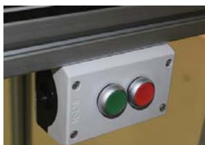
Figura 10 Botones de tarea terminada y de paro instalados en el puesto de trabajo.
