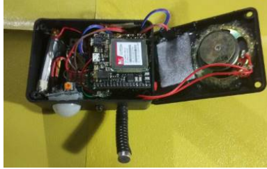
Figura 8 Detalle de colocación de componentes dentro de la carcasa.
