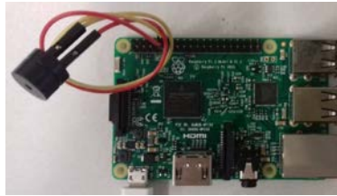
Figura 9 Implementación del sistema de terminal de alarma.
