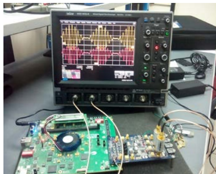
Figura 12 Banco de pruebas con la tarjeta Stratix III emulando el amplificador NXP 10 W.
