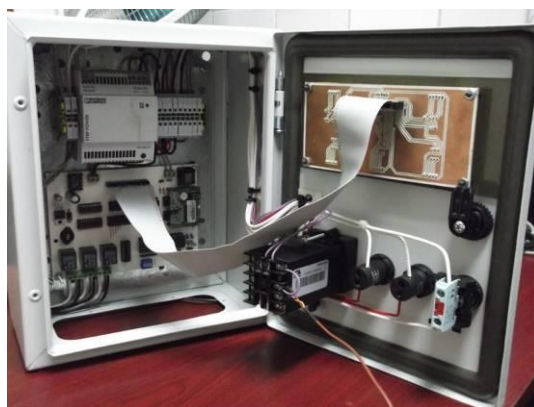
Figura 9 Vista del interior del monitor de temperatura construido.
