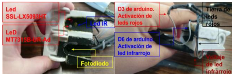
Figura 10 Montaje de dedal por dentro e indicación de donde va conectado cada cable.
