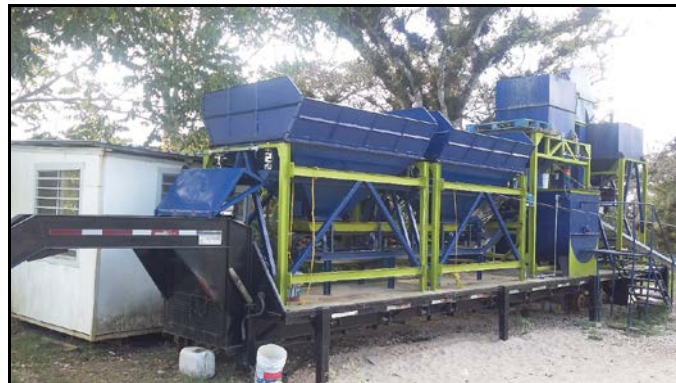
Figura 15 Planta Piloto de concreto seco.
