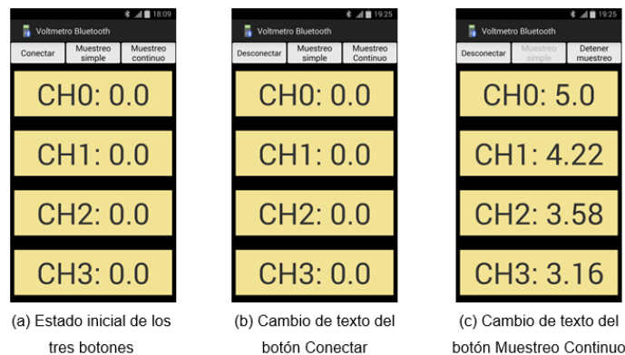
Figura 14 Despliegue de valores de voltaje en el teléfono inteligente.
