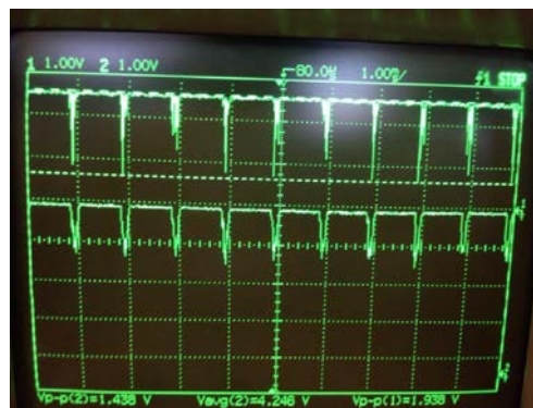
Figura 16 Señales transmisión (superior) y recepción (inferior), 1 kHz 3 cm de distancia.
