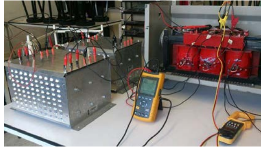
Figura 4 Medición de pérdidas en el transformador con carga lineal.
