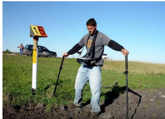
Figura 1 Inspección DCVG realizada por personal capacitado.
