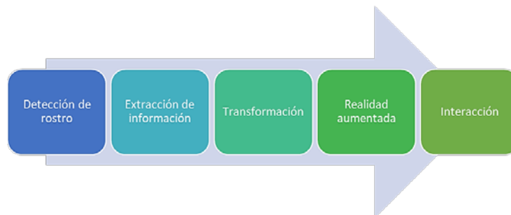
Figura 5 Diagrama de bloques de los módulos que conforman la aplicación móvil.
