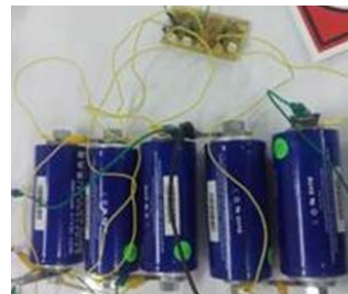
b) balanceo de voltajes activo con amplificadores
