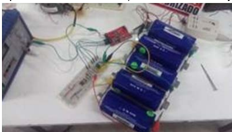
c) balanceo de voltajes activo con el chip BQ33100.
