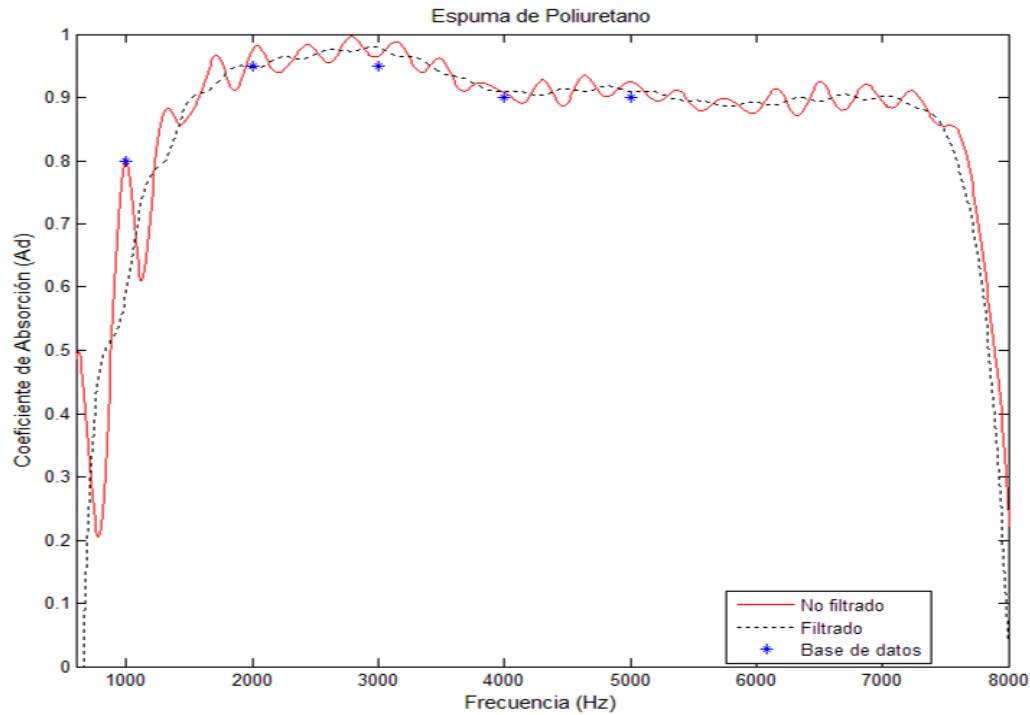
Figura 9 Coeficiente de absorción y transmisión, obtenida por la FT, y los tres valores obtenidos de una base de datos para 1, 2, 3, 4 y 5 kHz [Flores, 2013].
