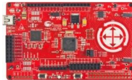
Figura 11 Microcontrolador PSOC 4 utilizado en el prototipo.
