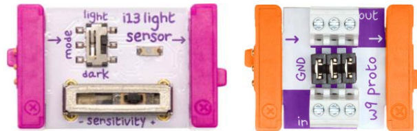
Figura 8 Recepción VLC con módulos LittleBits: Sensor de luz y proto.
