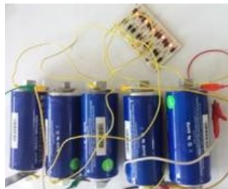
a) balanceo de voltajes pasivo con diodos.
